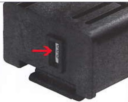
mit einer T 2A L/250V-Sicherung bestückt. Eine Ersatzsicherung liegt bei.
