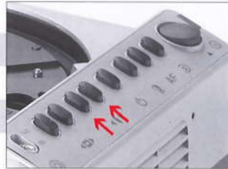
hängig aus- und einschalten. Die davor eingestellte Helligkeitsstufe wird dabei gespeichert und nach dem Line-up wieder aktiviert. Die externe Ansteuerung über P-Bus wird während der Einstellung unterdrückt. Mit Line-up wird auch der Standby-Betrieb (s.S. 15) beendet und die Dunkelblende (s.S. 16) geöffnet. Zum Einschalten der Line-up Funktion werden beide Transporttasten (21) am Projektor gleichzeitig für mindestens 1s gedrückt. Die Lampe leucht-
