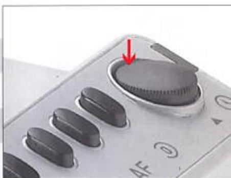
**Mit dem eingebauten Timer:** Mit dem eingebauten Timer können Sie Ihre Dias automatisch vorwärts transportieren lassen. Es lassen sich stufenlos Zeiten von ca. 2s bis ca. 60s einstellen. Zum Einschalten des Timers wird das Einstellrad (27) nach links (im Uhrzeigersinn) aus der rastenden Nullstellung gedreht. Als Anzeige leuchtet das Symbol rechts darunter auf dem Bedienpult auf. Durch weiteres Drehen nach links kann die Projektionsdauer nach Wunsch verkürzt
