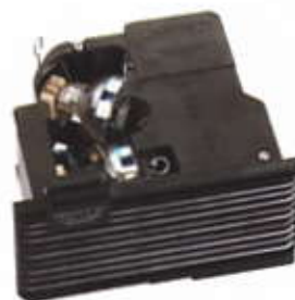
Das auswechselbare Lampenmodul mit beweglichem Umlenkspiegel sorgt für unterbrechungsfreien Betrieb, wenn die Hauptlampe einmal ausfallen sollte – und das in Sekundenbruchteilen.
