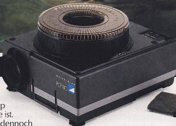
Wir haben schon die Diawechselvorrichtung erwähnt, die auf dem Schwerkraftprinzip beruht und damit die sicherste ist. Falls ein falsch montiertes Dia dennoch hängenbleibt, wird das Bild dadurch geschützt, daß der Motor sofort ausgekuppelt und nach etwa einer Sekunde ganz abgestellt wird.
